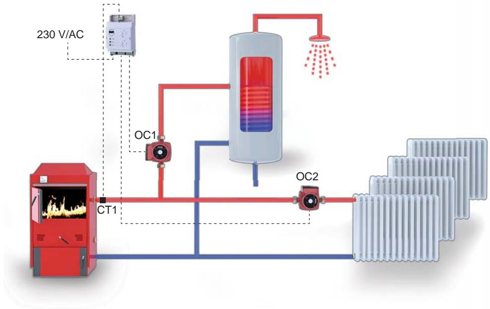
**Info:** Wenn es zur Störung des Sensors (Kurzschluss oder abgeschaltet) kommt, und die Anlage im Betriebsmodus AUTO arbeitet, erfolgt die Dauerkontaktgabe des Relais RE1 und RE2.
